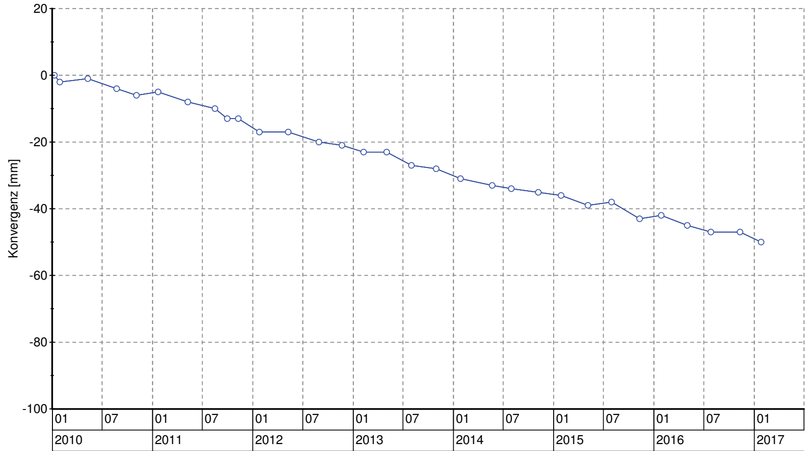
Konvergenzmessungen auf der 725-m-S ELK 7/725
