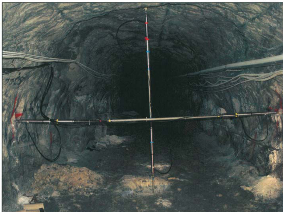
Abbildung 2.8: Beispiel eines Konvergenzkreuzes auf der 750-m-S - Messstelle T1
