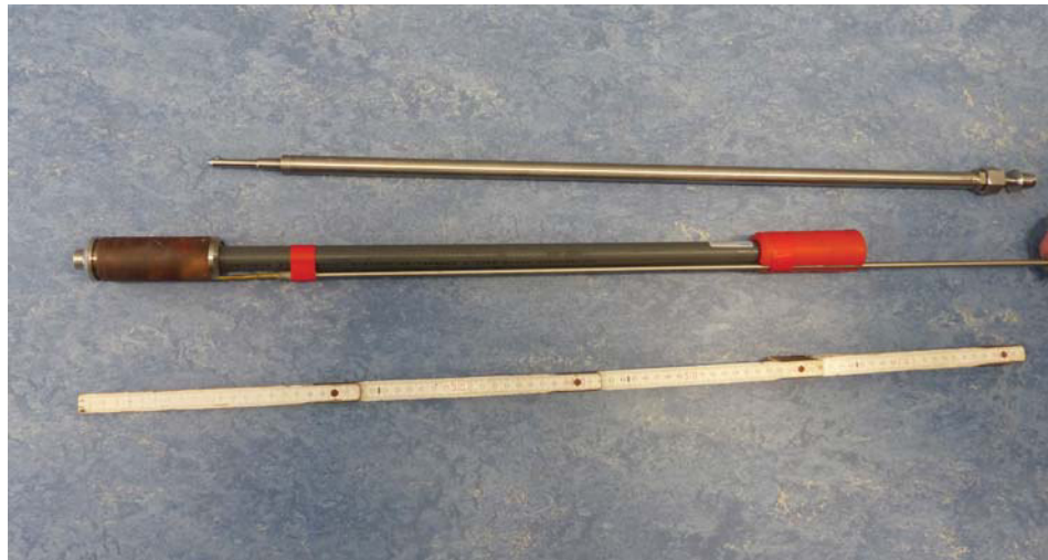
Abbildung 2.4: Hydraulischer Kupferpacker mit Messgestänge für Konvergenz-Messgerät BGKM 30 (Stoß und Firste)
