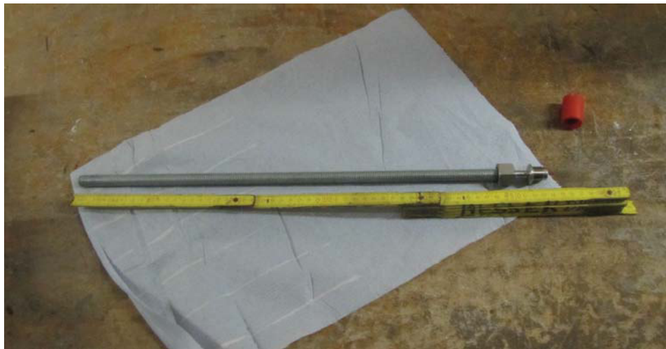
Abbildung 2.5: Konvergenzbolzen für Konvergenz-Messgerät BGKM 30 (Sohle)
